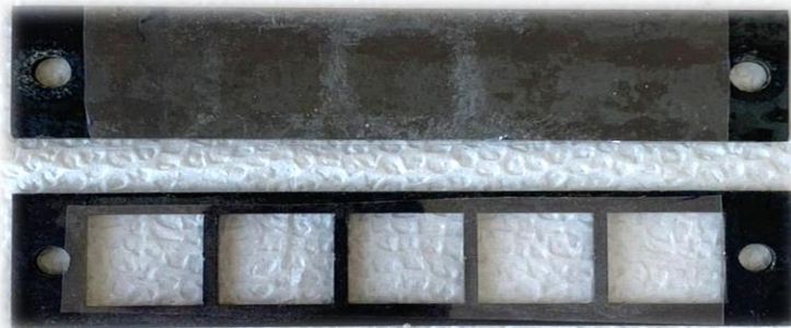
شكل 2: يبين القالب المعدني المستخدم في تحضير العينات
